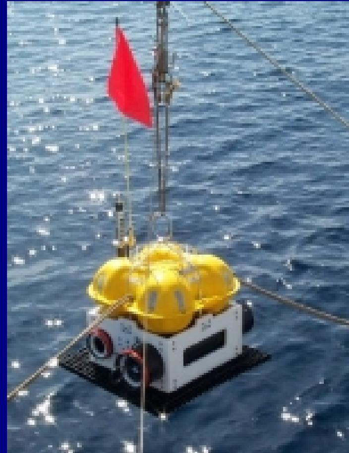
Sismomètre sous-marin, jusqu'à profondeur 6000m. Réseau GEO. [CNRS-INSU IPGP]
