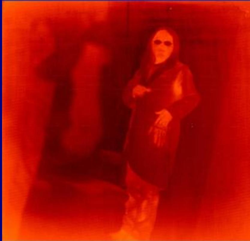
Si on n'éclaire pas une pièce et qu'on la photographie en IR, on ne voit que le rayonnement thermique :
